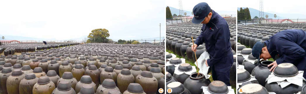
黒酢は「仕込み」「糖化・アルコール発酵」「酢酸発酵」「熟成」の4つの工程で造られます。発酵管理の見回りでは、醸造技師が五感を駆使して匂いと表面の「顔色」を見ます(写真A)。熟成の管理では状態を確認し、混ぜて空気に触れさせて熟成を促します(B)。一面に同じ大きさのつぼが並ぶ「つぼ畑」の眺めは圧巻です(C)。
